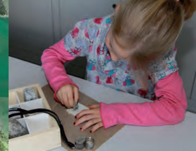
Gesteinsuntersuchung mit Strichtafel und Lupe © MMN
